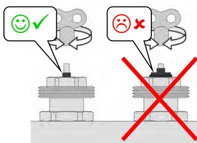
**RU** Мелкая резьба регулирующего шпинделя не должна выступать выше шестигранника SW19! Для полного открытия клапан из полностью закрытого состояния необходимо 2,5 - 3 оборота шпинделя против часовой стрелки (максимальный расход).
