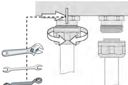
**RU** Удерживая гайку на выходе коллектора ключом SW24, закрутите накидную гайку ключом SW 30 (момент затяжки 25-30Нм).
