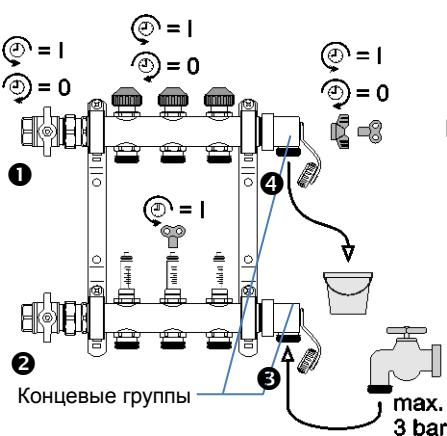
**RU** Закройте шаровые краны ① + ②. Закройте все регулирующие клапаны при помощи пластиковых колпачков (вращение по часовой стрелке до упора). Подключите шланг для наполнения и промывки к сливному крану концевой группы ③ подающего патрубка; сливной кран ④ концевой группы обратного патрубка должен быть полностью открыт!
