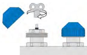
**RU** Снимите защитный колпачок и закройте клапан вращением (вправо) по часовой стрелке с помощью ключа воздухоотводчика (входит в комплект поставки).
