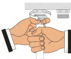
**RU** Закрутите вручную накидную гайку. Труба должна быть вставлена при этом до упора.
