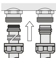
**RU** Вставьте готовую к монтажу трубу до упора в резьбовое соединение коллектора.
