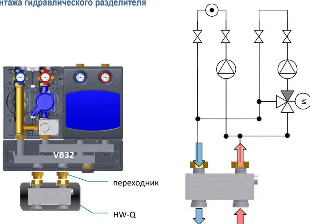
Для быстрого монтажа гидравлического разделителя к распределительному коллектору VB32 рекомендуется использовать 2 переходника (артикул 10027188) с уплотнениями (артикул 10020414).
