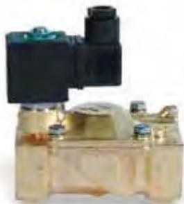
Соленоидный клапан для систем водоснабжения. Макс. давление 25 бар, рабочая температура от -10°C до +90°C. Имеются два типоряда: нормально закрытые (НЗ) и нормально открытые (НО).
