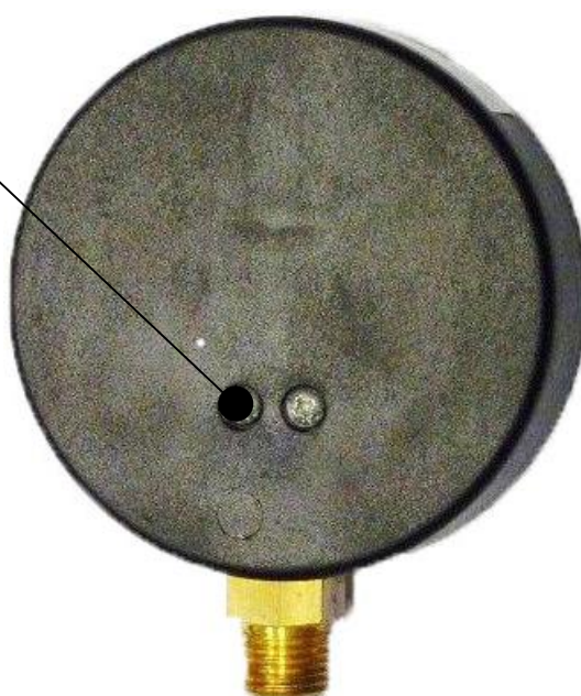
Фото 6 - Место пломбирования термоманометров F+R828, TIRM-ABS
