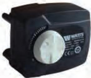
Электрический привод с 3-х точечным управляющим сигналом для поворотных смесительных и распределительных клапанов. Угол поворота 90° за 140 секунд, работа в автоматическом или ручном режиме.
