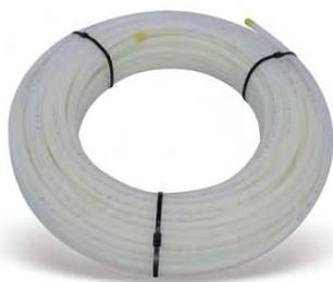
Полиэтиленовая труба с повышенной прочностью, изготовленная с помощью технологии, не использующей силан. С противодиффузионным слоем (EvoH), нанесенным на поверхность трубы. Может использоваться для напольного отопления. Соответствует требованиям IIP UNI 206, EN ISO 22391.
