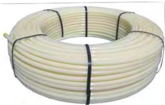
Труба из поперечносшитого полиэтилена (PEX) с противодиффузионным слоем (EvoH), нанесенным на поверхность трубы для предотвращения проникновения кислорода из окружающей среды в закрытую систему отопления. Может использоваться для напольного отопления. Повышенная максимальная температура длительной эксплуатации до 110 °С.
