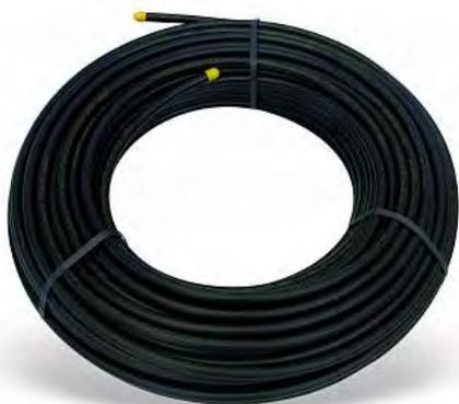
Труба из поперечносшитого полиэтилена неподверженная старяющему воздействию солнечных лучей. Предназначена в первую очередь для монтажа на улице, где возможно солнечное облучение. Остальные характеристики аналогичны PE-XB . Другие диаметры по запросу. Соответствует требованиям UNI EN ISO 15875-2
