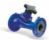
Балансировочный вентиль с фланцевыми присоединениями для систем отопления и водоснабжения. Вращение маховика регулирует размер проходного отверстия, меняя расход и перепад давления. Функция запирания, гидравлической балансировки, измерения расхода и перепада давления при помощи набора BVT-SET. Поле допуска коэффициента Kvs +/-5%. Значения Kv для каждого положения маховика вентиля для всех диаметров приведены в таблице.
